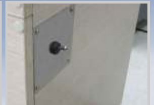
Coloque o purificador no local onde deverá ficar em definitivo, abaixe as travas das duas rodinhas dianteiras, ligue o plug do cabo em 220V e ligue a chave geral ao iniciar qualquer tipo de impressão
